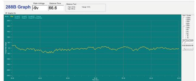
· Pulsed AC Ionizer는 유도대전을 유발하는 스위칭 전압 확인
