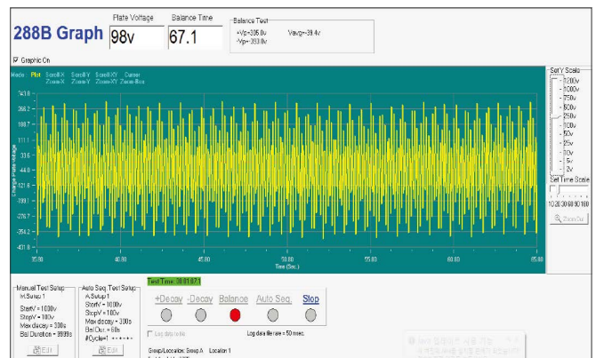
Pulsed AC 방식의 이온라이저는 높은 AC 유도 대전 발생 Peak-to-Peak 값: +305V to - 393V
