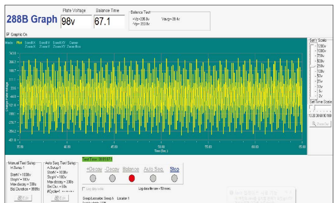
Pulsed AC 방식의 이온나이저는 높은 AC 유도 대전 발생
